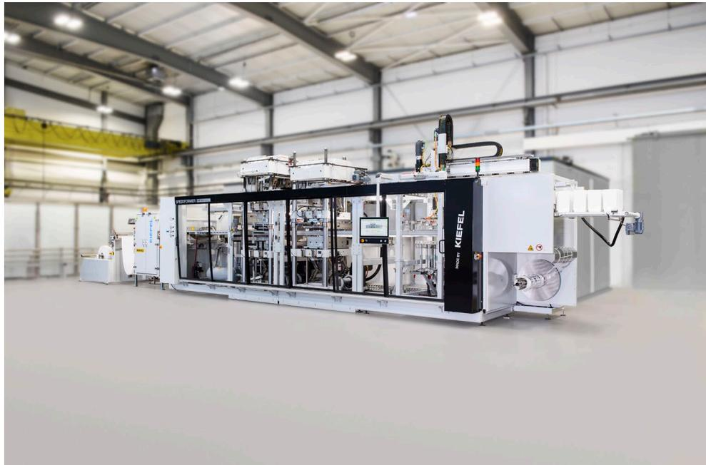
Die neue KMD 78.2 Premium bietet einen höheren Ausstoß an Polymerverpackungen und erreicht bis zu 45 Takte/Min. © KIEFEL GmbH
