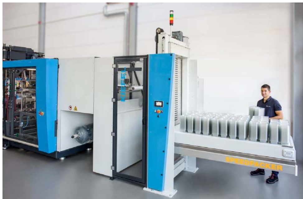
Fig.: la estación de almacenamiento y de descarga SpeedPacker para la serie de máquinas KMD Speedformer.
