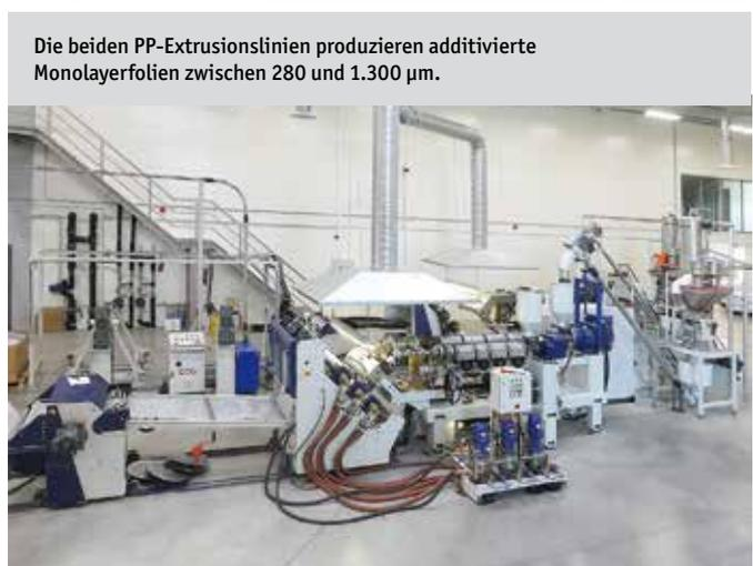
Die beiden PP-Extrusionslinien produzieren additierte Monolayerfolien zwischen 280 und 1.300 µm.
