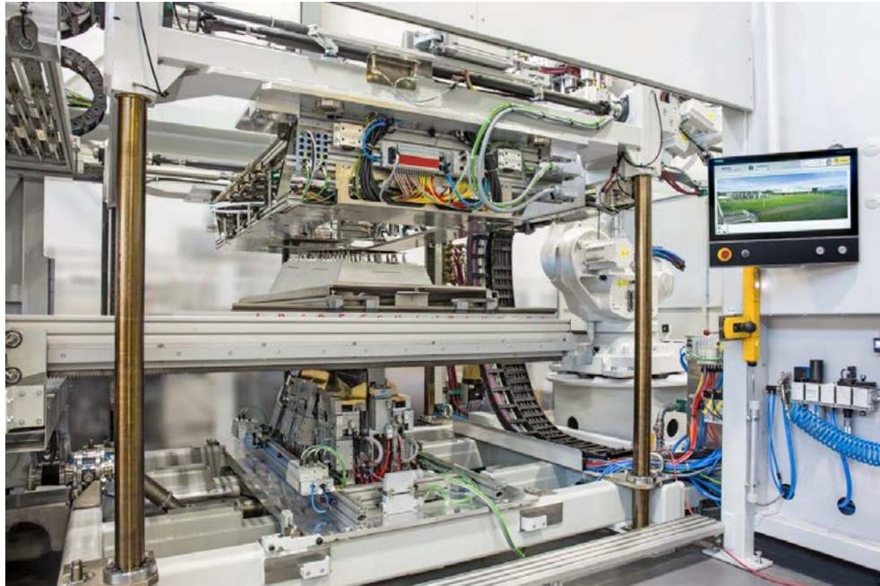
***BU: Kaschierstation der TBL-Vakuumkaschieranlage.***
