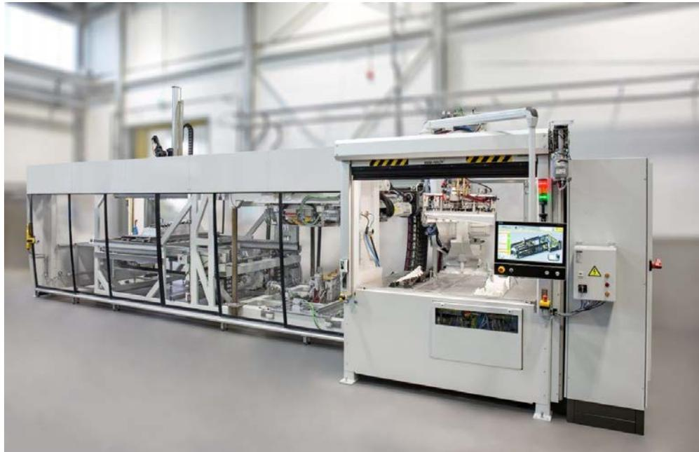
***BU: Neue hochautomatisierte und modular aufgebaute Kiefel-Vakuumkaschieranlage nach dem TBL Verfahren (Tailored-Blank-Laminating).***
