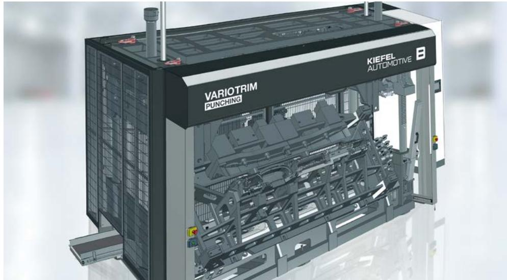
***BU: VARIOTRIM – Stanzanlage mit integriertem Werkzeug***
